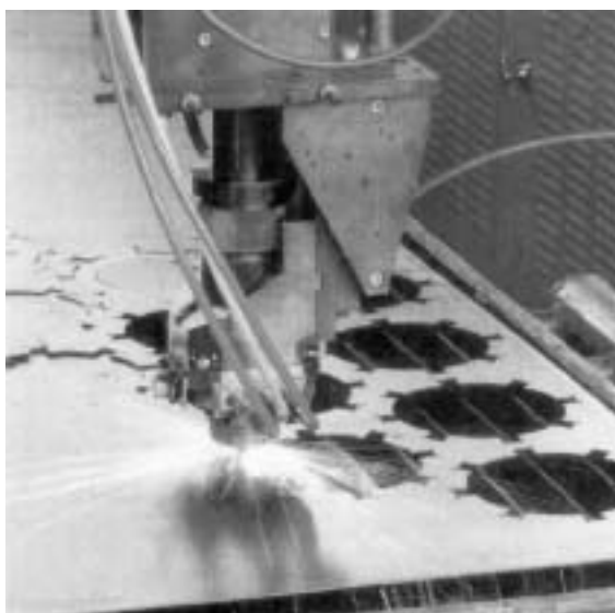
Obr. 21: Příklad vyřezávání součástek \text{CO}_2 -laserem
