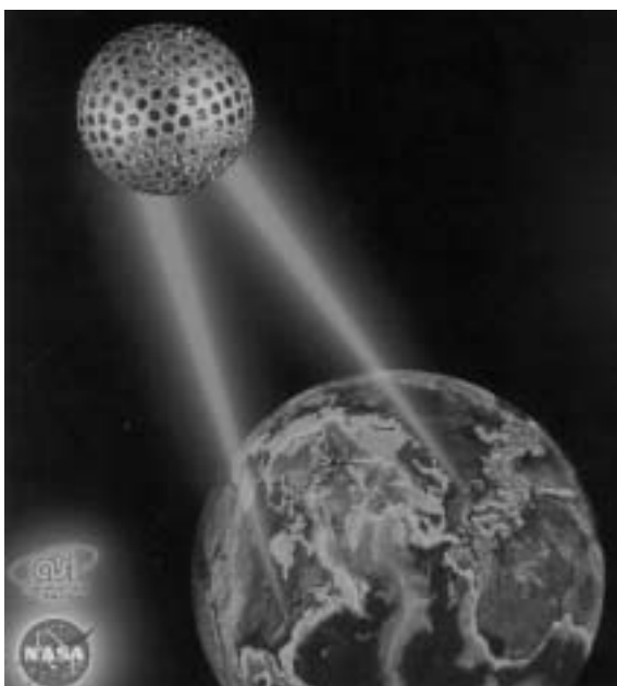
Obr. 23: Měření vzdálenosti k umělé družici LAGEOS (Laser GEOdynamics Satellite) pomocí Nd:YAG pulsního laseru s konverzí vlnové délky z infračervené na zelenou.
